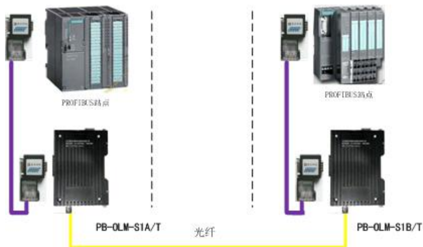
图 1-5、采用单根光纤进行点对点组网
